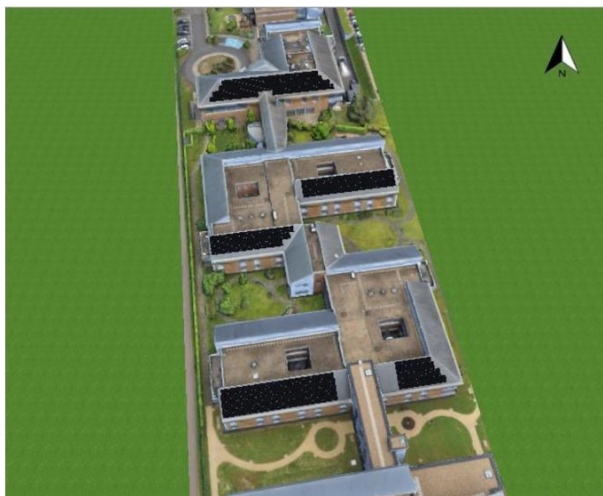
Figure 2 : Simulation 3D de l'installation photovoltaïque prévue sur le bâtiment de l'ALA à Erpeldange (source : CEA)
